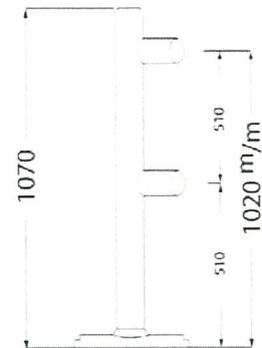
Stahlstandfuß H 1070 mm, Ø 50 mm, mit Abdeckkappe, Fußabdeckplatte 180,x,110 mm aus Stahl. Muffen aus PC-Hartkunststoff verchromt.
